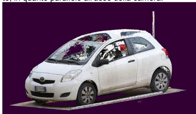
Dalla Tabella 3 notiamo chiaramente come la precisione delle nuvole si riduca con la qualità della camera. Inoltre camere di qualità inferiore comportano più rumore e più punti errati, cioè punti collocati a distanze rilevanti dalla superficie del mezzo. Si noti infine come la densità delle nuvole decresca con la diminuzione della qualità della camera.
